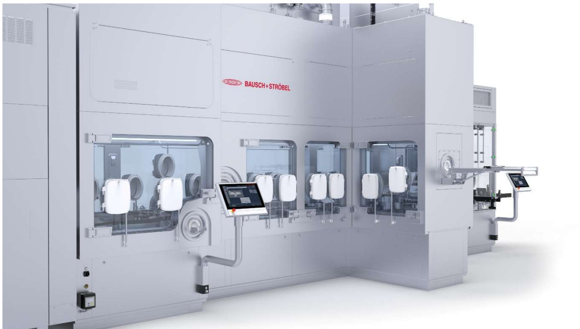
Die auf der Messe ausgestellte Füll- und Verschließmaschine mit integriertem Isolator vereint modernste Abfülltechnologie mit einem darauf abgestimmten Containment
