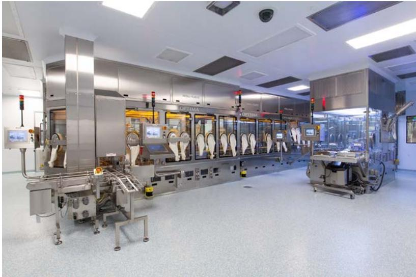
Metall+Plastic Isolator in Kombination mit einer Füll-Linie von Optima Pharma. Foto: Optima
