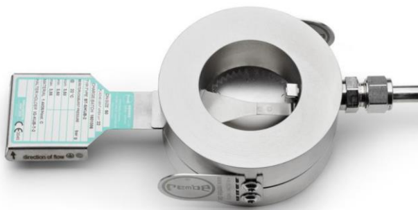
Abb. 4: Öffnet die KUB Berstscheibe, gibt der NIMU Sensor eine Information an das Prozessleitsystem der Anlage.
