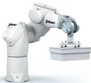
TX2-60 ihr Debut feierte. Diese Roboterbaureihe zeichnet sich durch eine abermals verbesserte Reinigungsfähigkeit, eine neue FDA-konforme Oberflächenbeschichtung, verfeinerte Dichtungen und weitere Aufwertungen im Hygienesdesign aus. Zusammen decken Stericlean und Stericlean+ alle Anforderungen in Produktionsbereichen der Klasse A/B ab und erfüllen die höchsten Hygienestandards in Isolatoren, RABS, Gefriertrocknern und Autoklaven.
