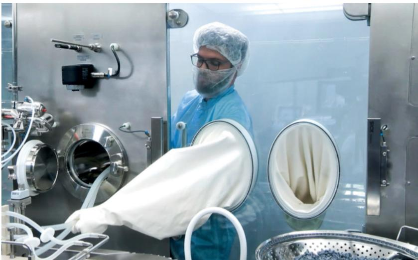
Abbildung 2: Anwender bei der Bedienung eines Liquid-Transfer-Containers, angedockt an einen Alpha-Port.
