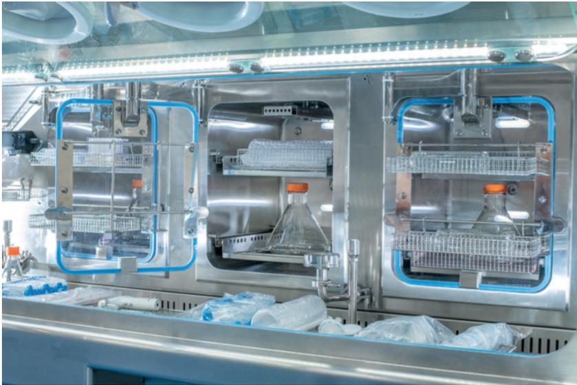
Abbildung 1: Dekontaminierbare Autoklaven im Klasse-A-Isolator für ATMP-Herstellung (Quelle aller Abbildungen: ProSys Group).
