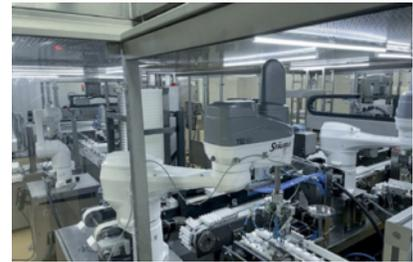
Die Roboter handhaben und prüfen die Spritzen-Nester und legen diese nach Prüfung in einen Behälter ab.
