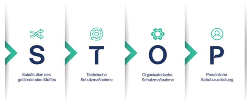
Abbildung 1: STOP-Prinzip: Diese Schutzmaßnahmen sind in der entsprechenden Reihenfolge anzuwenden, da nur so eine Beeinträchtigung des Menschen am geringsten ist (Quelle aller Abbildungen: HET Filter GmbH).
