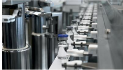
Abbildung 3: Bördelkappe – eine Verschlussmöglichkeit der primären Verpackung.
