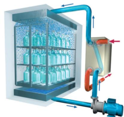
Flüssigkeiten in geschlossenen Behältni-sen können mit dem direkten Heißwasser-Berieselungsverfahren sterilisiert werden.
