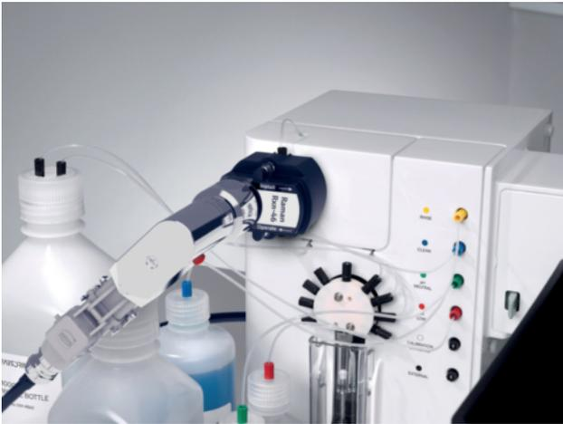
**Abbildung 1:** Eine spezielle Raman-Sonde, integriert in ein modernes Analysesystem für Bioreaktoren, ermöglicht eine schnellere, einfachere und robustere Erstellung von Modellen (Quelle aller Abbildungen: Endress+Hauser).
