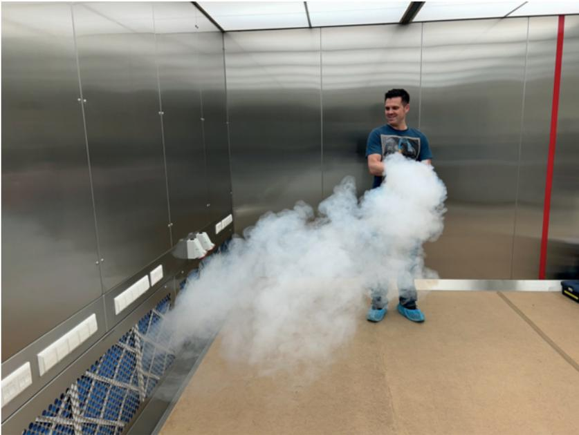
**Abbildung 2: Strömungsvisualisierung im Rahmen der Validierung einer Probenzugkabine.**
