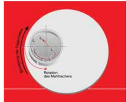
Abb. 3: Funktionsprinzip der Planeten-Kugelmühle.
