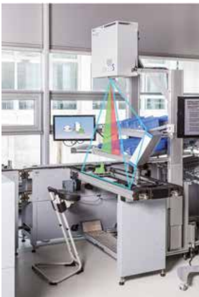
Abbildung 5: Verkettung von Informationssträngen zur Optimierung bei repetitiven Prozessen am Beispiel eines Montagearbeitsplatzes im Fraunhofer Applikationszentrum Industrie 4.0. Durch objektbezogene Visualisierung können z. B. regulierte Prozessanweisungen (SOPs) vereinfacht oder ersetzt werden.
