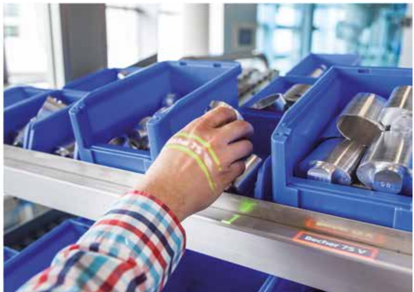
Abbildung 5: Verkettung von Informationssträngen zur Optimierung bei repetitiven Prozessen am Beispiel eines Montagearbeitsplatzes im Fraunhofer Applikationszentrum Industrie 4.0. Durch objektbezogene Visualisierung können z. B. regulierte Prozessanweisungen (SOPs) vereinfacht oder ersetzt werden.
