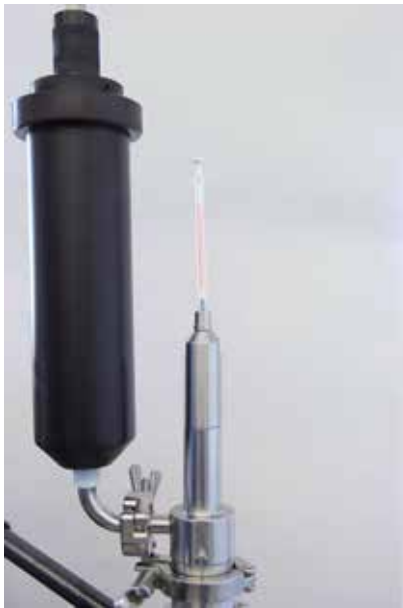
Abbildung 2: Dosierspritzenabfüllung durch den Konus.
