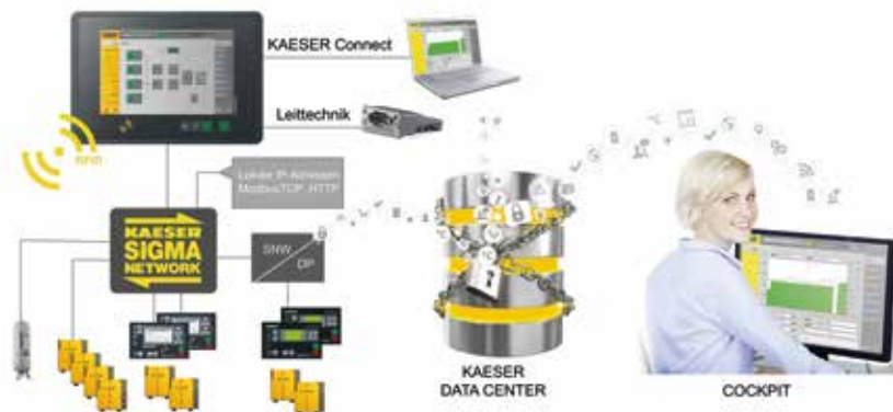
Abbildung 3: Die übergeordnete Steuerung fungiert als Managementsystem für die Druckluftkomponenten und als Knotenpunkt für die sichere Datenübertragung.
