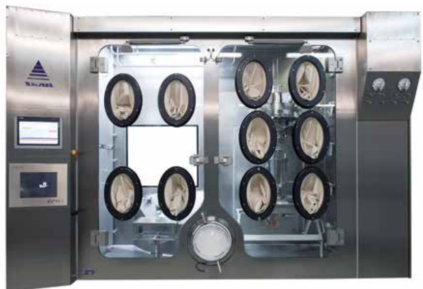
Abbildung 1: Containment für Verwiege-, Misch- und Abfüllprozess mit Rapid-Transfer-Port (RTP)-Systemen und washdown-fähigen Safe-Change-Filtern. Die Anlage ist geeignet zur Einhaltung eines OEL \leq 0,1 \mu\text{g}/\text{m}^3 und voll Washing-In-Place (WIP)-fähig (Quelle alle Abbildungen: SKAN AG).
