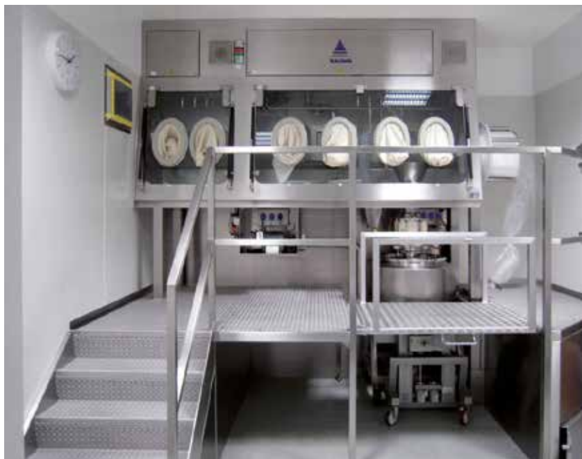
Abbildung 2: Isolator zur Verriegelung von HPAPI mit Schleuse, Endlosliner und Doppelklappe. Die Anlage ist geeignet zur Einhaltung eines OEL \leq 1 \mu\text{g}/\text{m}^3 und WIP-fähig.
