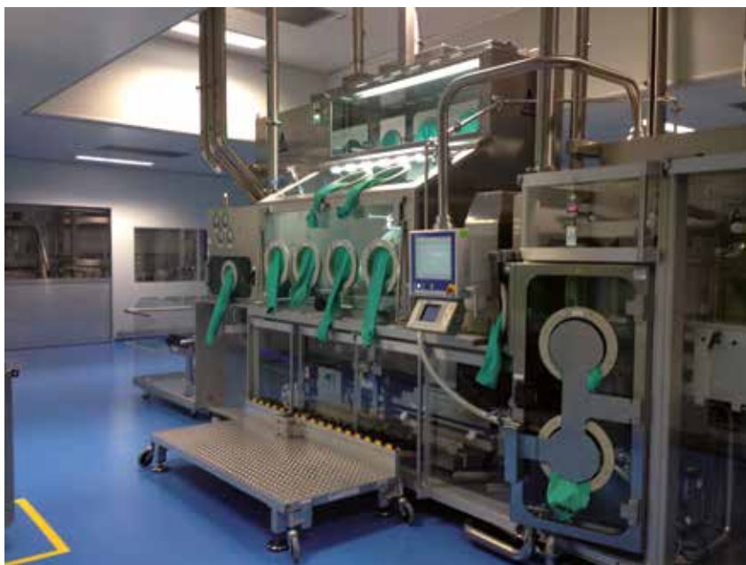
Abbildung 3: Anlage zur Blisterverpackung von Kapseln und Tabletten mit Mouseholes mit Luftvorhang. Die Anlage ist geeignet zur Einhaltung eines OEL \leq 1 \mu\text{g}/\text{m}^3 .
