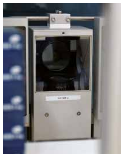
Abbildung 8: Eine hochauflösende Kamera liest die Seriennummern ein. Die Linienmanagementsoftware PLM erstellt die Datenhierarchie, die für eine Aggregation notwendig ist (Quelle: Mettler-Toledo PCE).
