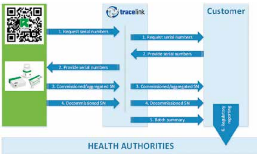
Abbildung 5: Datenfluss zwischen Pharmaproduzent, Netzwerk-Provider, Kunden und Regierungsbehörden bei Serialisierung und Aggregation (Quelle: R-Pharm Germany GmbH).
