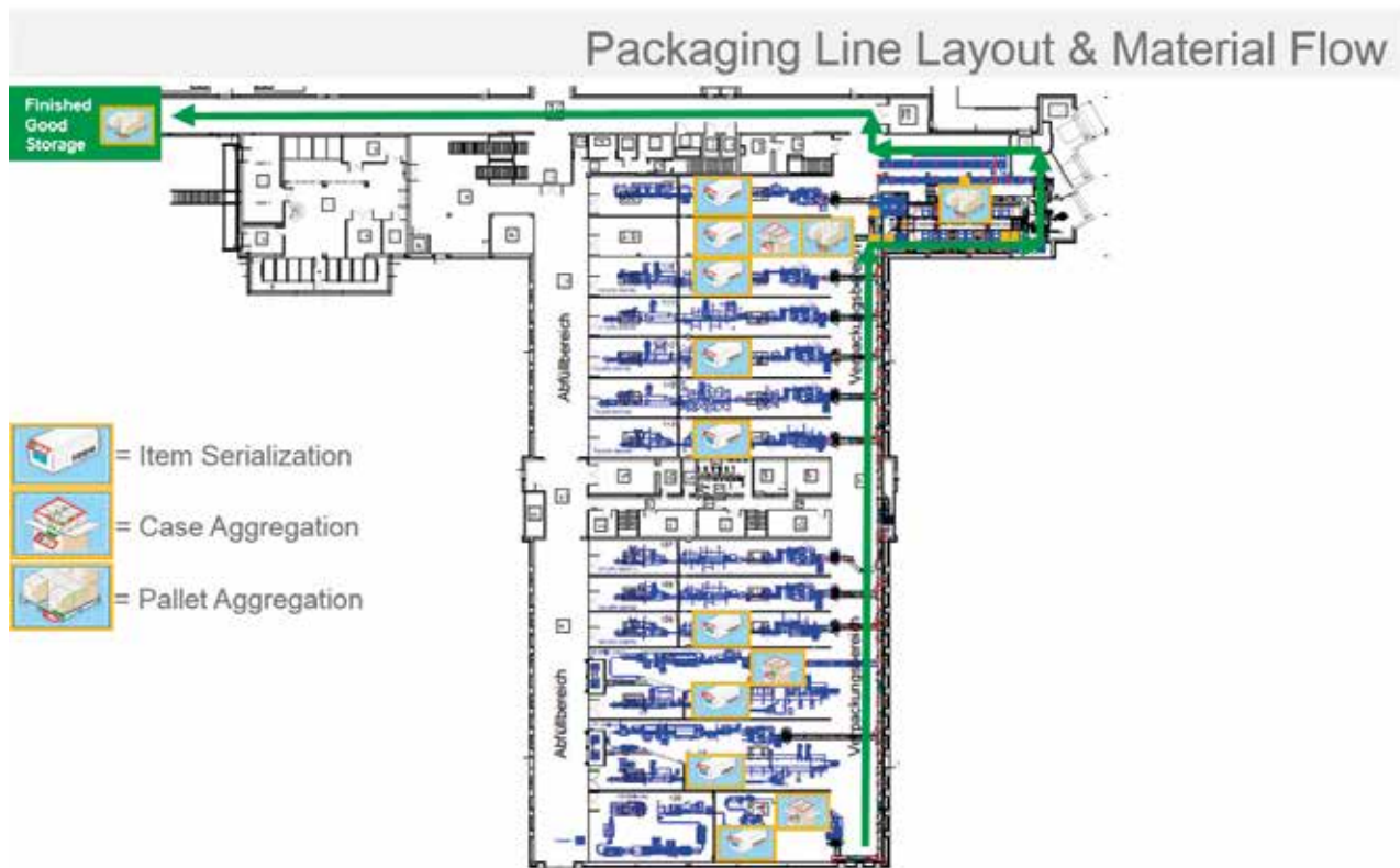
Abbildung 2: Layout des Verpackungsbereiches für Serialisierung und Aggregation auf Umkarton- und Palettenebene (Quelle: R-Pharm Germany GmbH).
