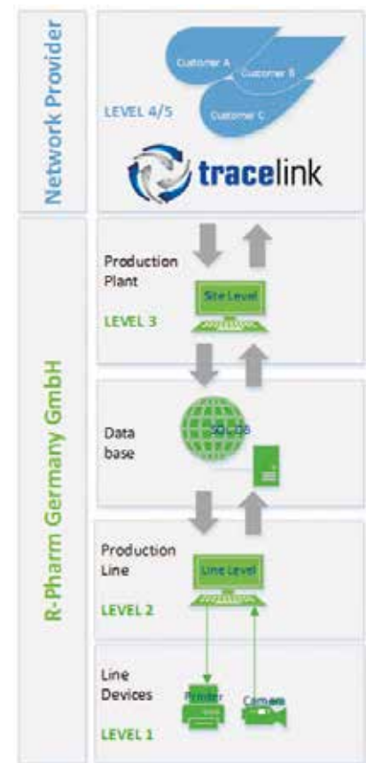
Abbildung 6: Track & Trace-Systemarchitektur im Überblick (Quelle: R-Pharm Germany GmbH).
