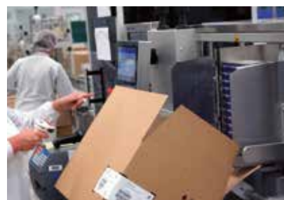
Abbildung 7: Auf der Multi-Line kann der Pharmaproduzent Arzneimittelverpackungen halbautomatisch serialisieren und aggregieren (Quelle: Mettler-Toledo PCE).
