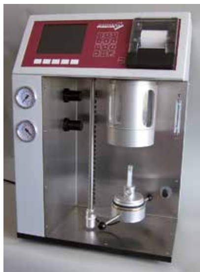
Abbildung 5: Für die Analyse von Proteinlösungen werden Partikelzählssysteme mit einer kleineren Druckkammer ausgestattet. So können auch geringere Probenmengen höherer Viskosität unter Druck analysiert werden.
