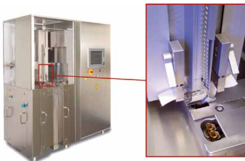
Abbildung 6: Kontrollwaage zur Verwiegung von 2-bahnigen Blisterstreifen. Die Blisternäpfe werden paarweise durch Abziehen der Deckfolie geöffnet und der Inhalt in 2 Wägebehälter transferiert (rechtes Bild). Die Wiegezellen haben 20 µg Auflösung (Quelle: Harro Höfliger).
