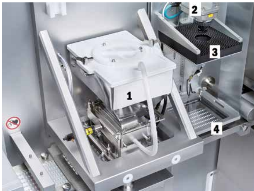
Abbildung 2: In Blisterlinie integriertes Membranfüller-Modul. 1: Membranfüller, 2: Kamera, 3: Beleuchtung, 4: Dunkelfeldbeleuchtung (Quelle: Harro Höftiger).
