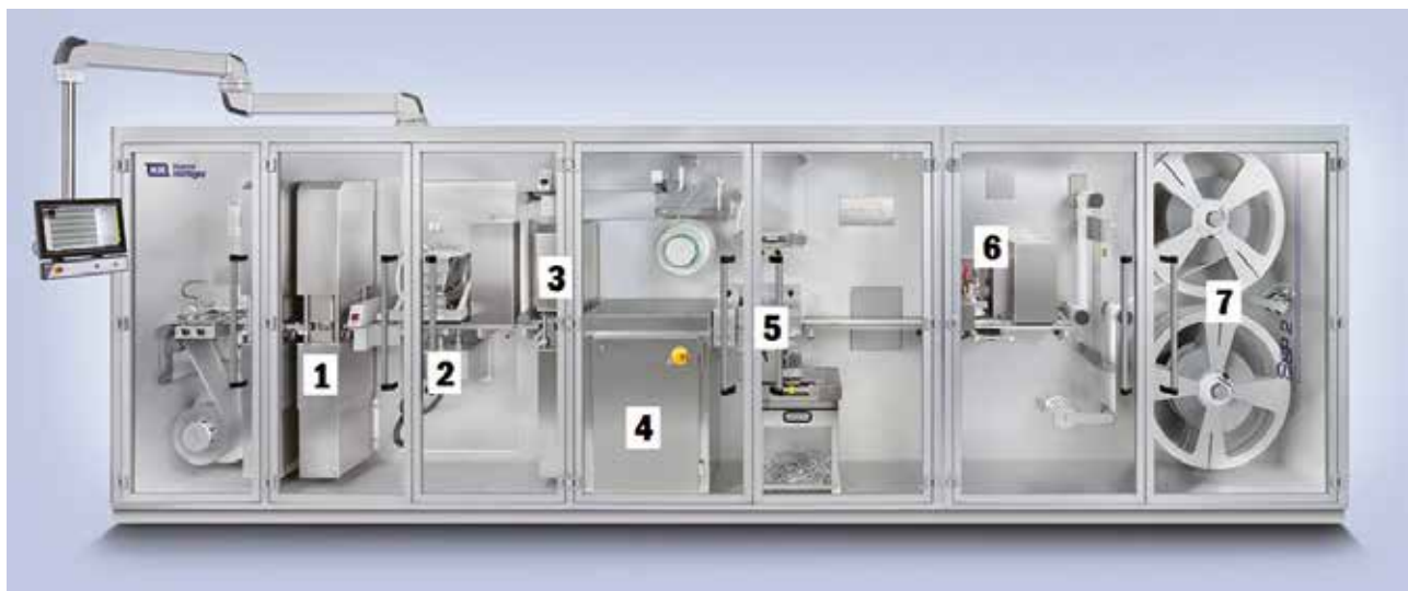
Abbildung 8: Maschine zur Herstellung pulverbefüllter Blisterstreifen. 1: Formstation, 2: Membranfüller, 3: Siegelstation, 4: Internationale-Patentklassifikation(IPC)-Röntgenmodul, 5: Längsschneiden, 6: Bedruckung mit Kamerakontrolle, 7: Aufwickeln (Quelle: Harro Höfliger).
