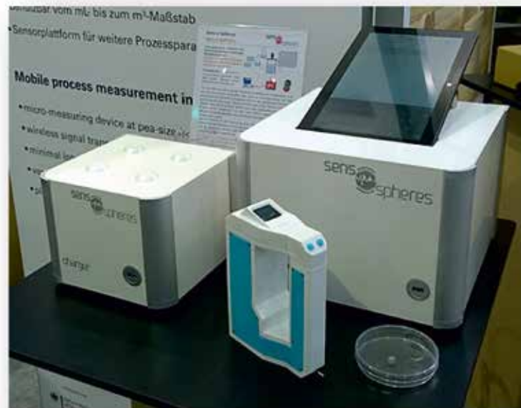
Abbildung 6: Demonstrator der Sens-o-Spheres. Zu sehen sind das Ladegerät, die Basisstation, die Sensorkugeln in einer Petrischale und ein Handapparat, um die Sphären steril zu applizieren (Quelle: Technische Universität Dresden).
