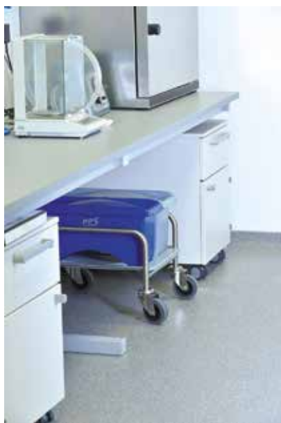
Abbildung 5: Platzsparender Systemwagen für kleinere Reinräume (Quelle: Pfennig Reinigungstechnik).
