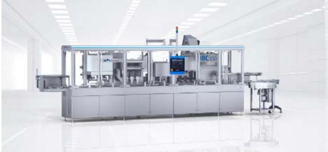
Pharma-Verpackungslinie IBC 150 mit innovativer Einzeltablettenausscheidung: Damit lässt sich der Ausschuss beim Abfüllen von Tabletten in Flaschen um bis zu 99 Prozent reduzieren.
