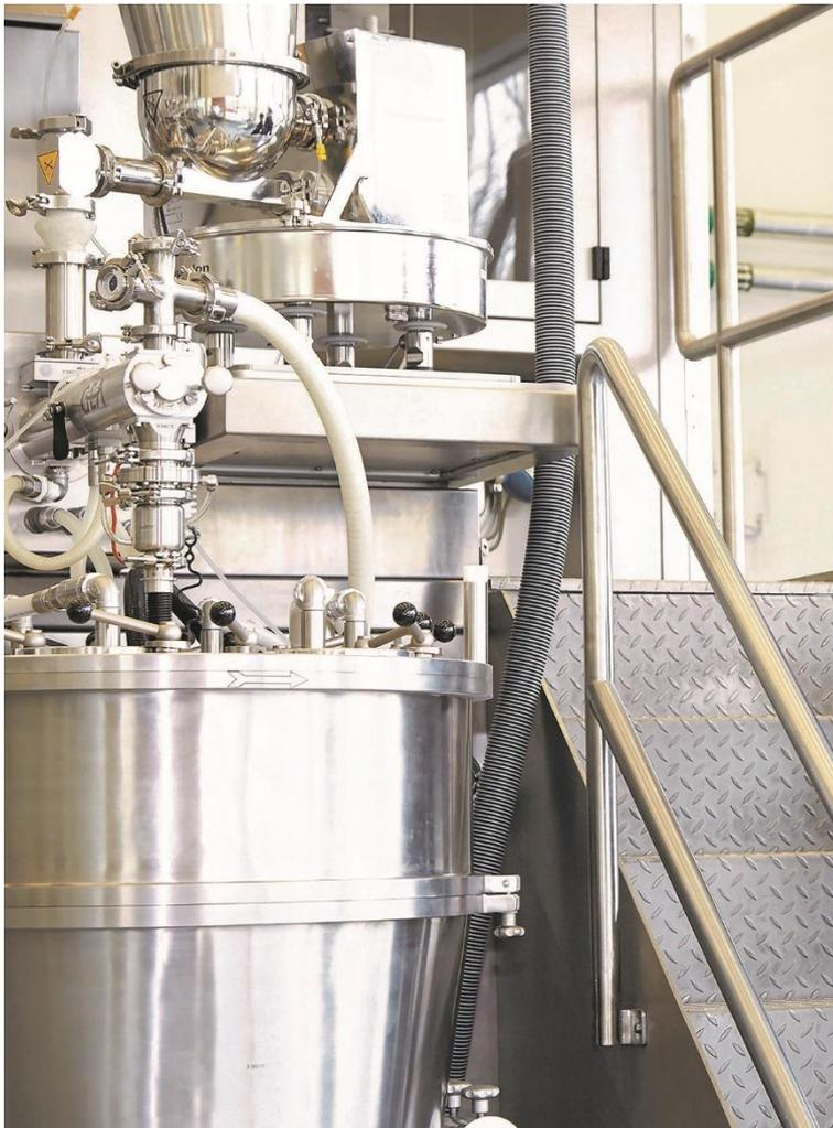
Foto: Der Kern der Anlage in Sheffield ist die kontinuierliche Tablettierungslinie Consigma® CTL 25 von GEA, eine Mehrzweckplattform, die zur Herstellung von Tabletten aus Pulver in Entwicklungs-, Versuchs, Studien- und Produktionsvolumen in einer einzigen kompakten Anlage konzipiert wurde. (Bild: University of Sheffield)
