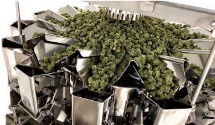
Die Mehrkopfwage CCW-RV-214-05 bietet Geschwindigkeit und Präzision bei der Verarbeitung von medizinischem Cannabis. (© Ishida)
