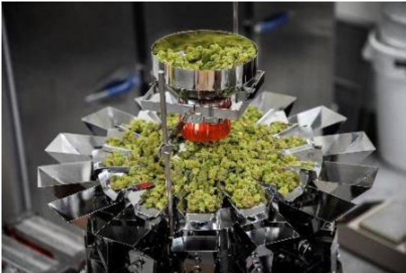
Die Mehrkopfwage CCW-RV-214-05 bietet Geschwindigkeit und Präzision bei der Verarbeitung von medizinischem Cannabis. (© Ishida)
