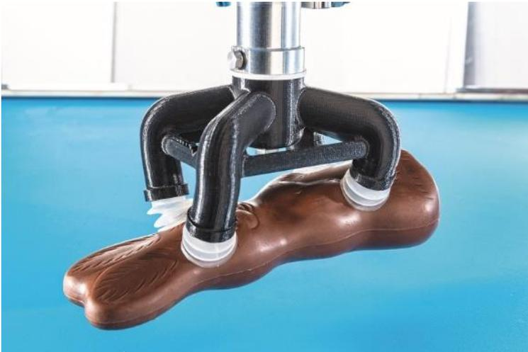
Die konstruktive Freiheit des 3D-Drucks erlaubt optimal geformte Werkzeuge auch für zerbrechliche und komplexe Produktformen.
