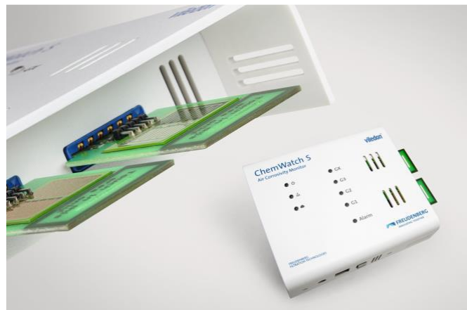
Die ChemWatch S von Freudenberg liefert Informationen über die Korrosionsgefahr durch saure Gase.
