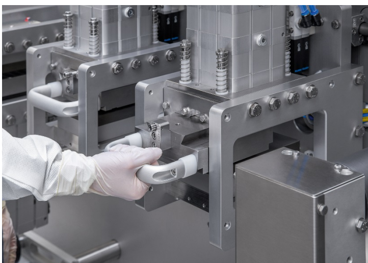
Wechsel von Schneidwerkzeugen an der OPTIMA TDC125
