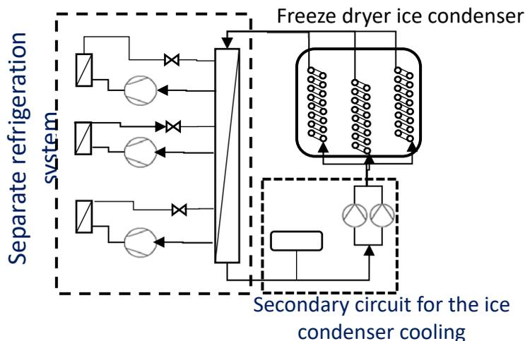
Indirekte Kühlung des Eiskondensators: Brennbares Kältemittel befinden sich in der Kälteanlage. Diese kühlt das Silikonöl, das durch die Kühlschlangen des Eiskondensators fließt. Die Kühlschlangen im Eiskondensator müssen darauf ausgelegt sein.
