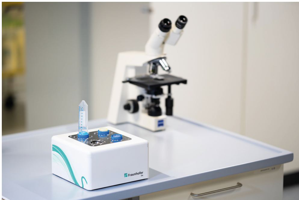
Der Tissue-Grinder separiert Zellen schonend. Quelle: Fraunhofer IPA
