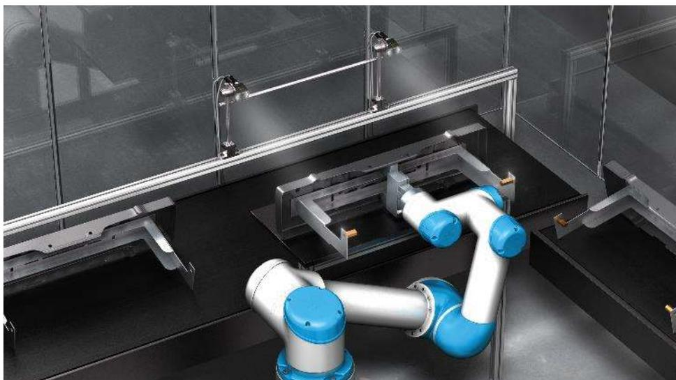
Bild 2: Vision Sensor CS 50 von di-soric: erkennt Gegenstände im Bereich zwischen 75 mm und 1200 mm mit größtmöglicher Tiefenschärfe
