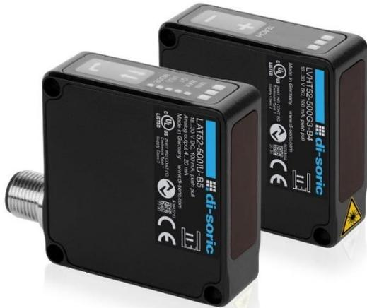
Bild 1: Laser-Abstandssensoren LAT-52 von di-soric messen kleinste Abstandsänderungen im Sub-Millimeterbereich mit höchster Genauigkeit. Für hochgenaues Schalten kommt die Variante LVHT-52 zum Einsatz.
