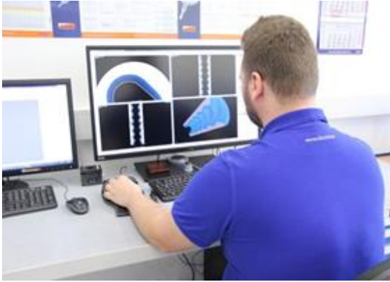
Abbildung 3: Vermessung der Statore und Bildauswertung der Tropfengröße eines bestimmten Volumens unter dem Mikroskop mithilfe einer speziellen Software.
