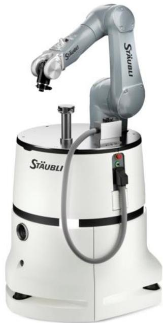
Mobiles Robotersystem HelMo im Einsatz mit einem TX2-90L Roboterarm
