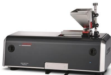
Partikelmessgerät ANALYSETTE 28 ImageSizer zur Trocken-Messung von Pulvern und Schüttgütern
