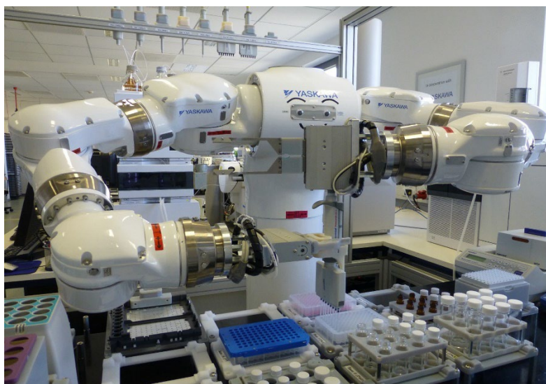
Yaskawa-Roboter Motoman CSDA10F im Einsatz in der automatisierten Probenvorbereitung. Der Roboter nutzt dabei klassische Multipipetten aus der manuellen Laborarbeit. (Quelle: CELISCA)
