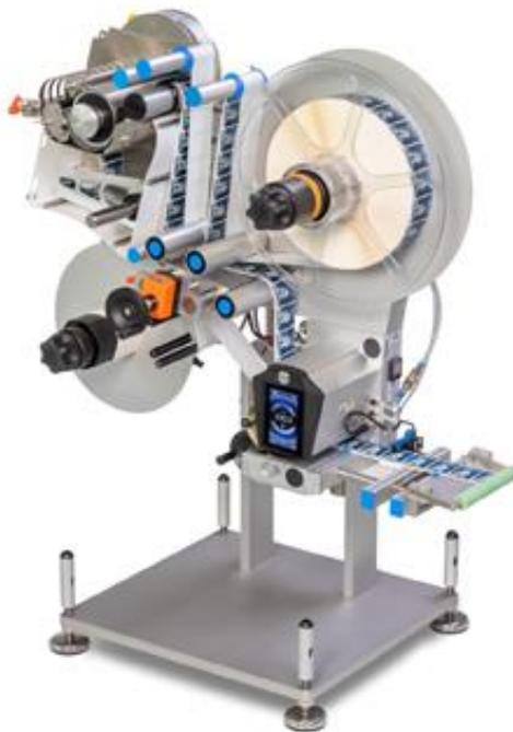
Weltrekordverdächtige Marathonleistung: Der HERMA 500 schafft eine Etikettierleistung von bis zu 200 Metern in der Minute synchron zur Produktgeschwindigkeit – nonstop im Dauerbetrieb. Möglich machen das motorische Winder, eine Schlaufeneinheit und eine integrierte, aktive Kühlungseinheit.
