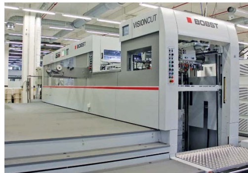
Bild 2: Bobst VisionCut 106 mit automatischer Inline-Nutzentrennung.
