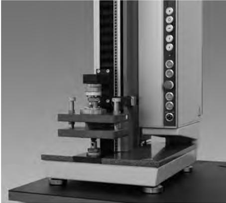
Abb. 4-1. Prüfgerät für den Kantenstauchversuch nach ISO 3037.
