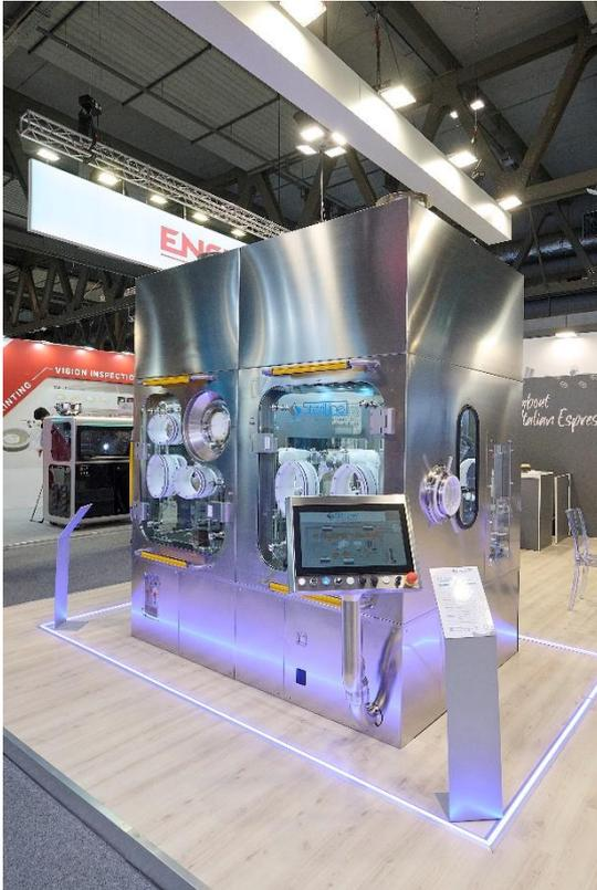
Darüber hinaus bietet die RVFCM11-S mit einer Produktionskapazität von 15 Flaschen, Spritzen oder Karpulen in Nest pro Minute einen äußerst schnellen Dekontaminationszyklus mit verdampftem Wasserstoffperoxid – ideal für einen effizienten Loswechsel.
