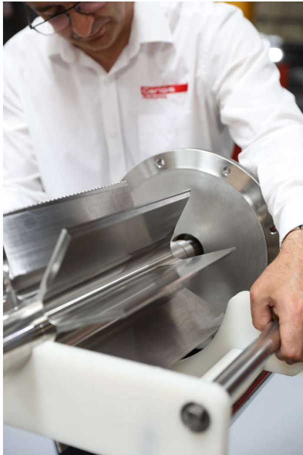
Rotorausbau bei einer Gericke RotaVal Schnellreinigungsschleuse
