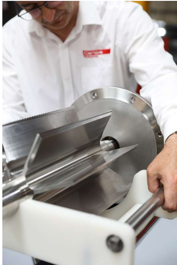
Rotorausbau bei einer Gericke RotaVal Schnellreinigungsschleuse
