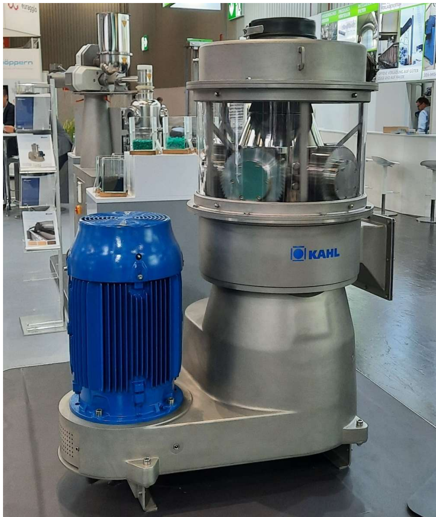
Die Flachmatrizenpresse 33-600 ist für den industriellen Einsatz konzipiert und optional nach GMP-Richtlinien zertifizierbar.
