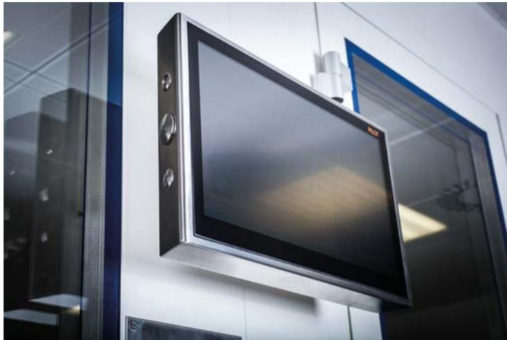
Foto: HMI-System PILOT, Wandmontage im Reinraum
