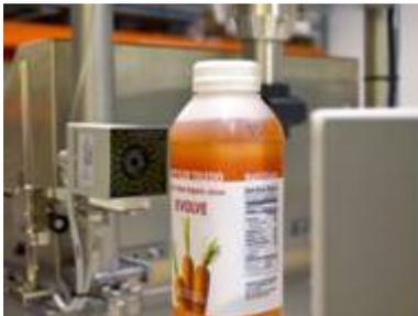
*Von der Verschlusskappenkontrolle bis hin zu Füllstandsmessung: V2622 Flex-Lite von METTLER TOLEDO eignet sich für eine Vielzahl kamerabasierter Inspektionen.*
