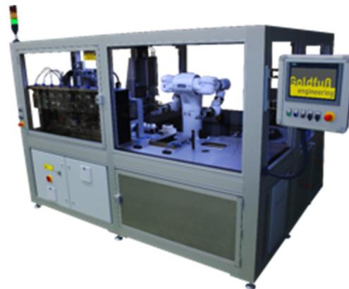
In einem aktuellen Entwicklungsprojekt werden mit dem CSDA10F etwa ein Dutzend Prozesse für die vollautomatische Produktion von Nanopartikeln verkettet ausgeführt. (Quelle Anlage: Goldfuß engineering GmbH)
