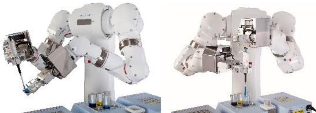
Ein speziell für die Laborautomatisierung entwickelter Roboter ist der Dual-Arm-Roboter Motoman CSDA10F von Yaskawa. (Quelle: Yaskawa)
