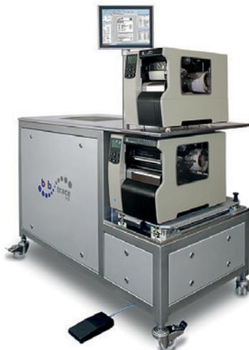
**STS** – eine Station für das Einlesen bereits serialisierter Produkte. Die mit Seriennummern bedruckten und etikettierten Packungen werden auf das Sichtfeld des Arbeitstisches gelegt, und eine Kamera meldet die erfassten Codes an die Datenbank.
