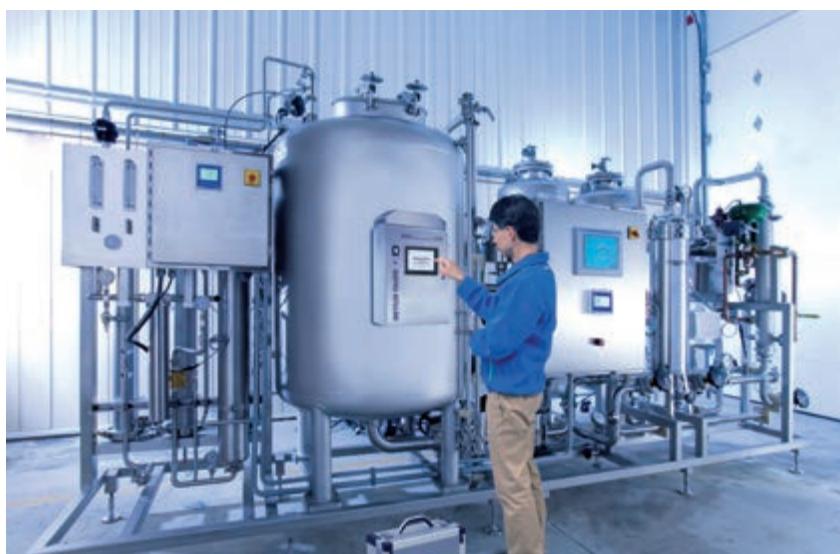
Abbildung 5: Typischer Einblick in eine Wasseranlage mit dem Einsatz der neuen Online-Keimzahlbestimmung.
