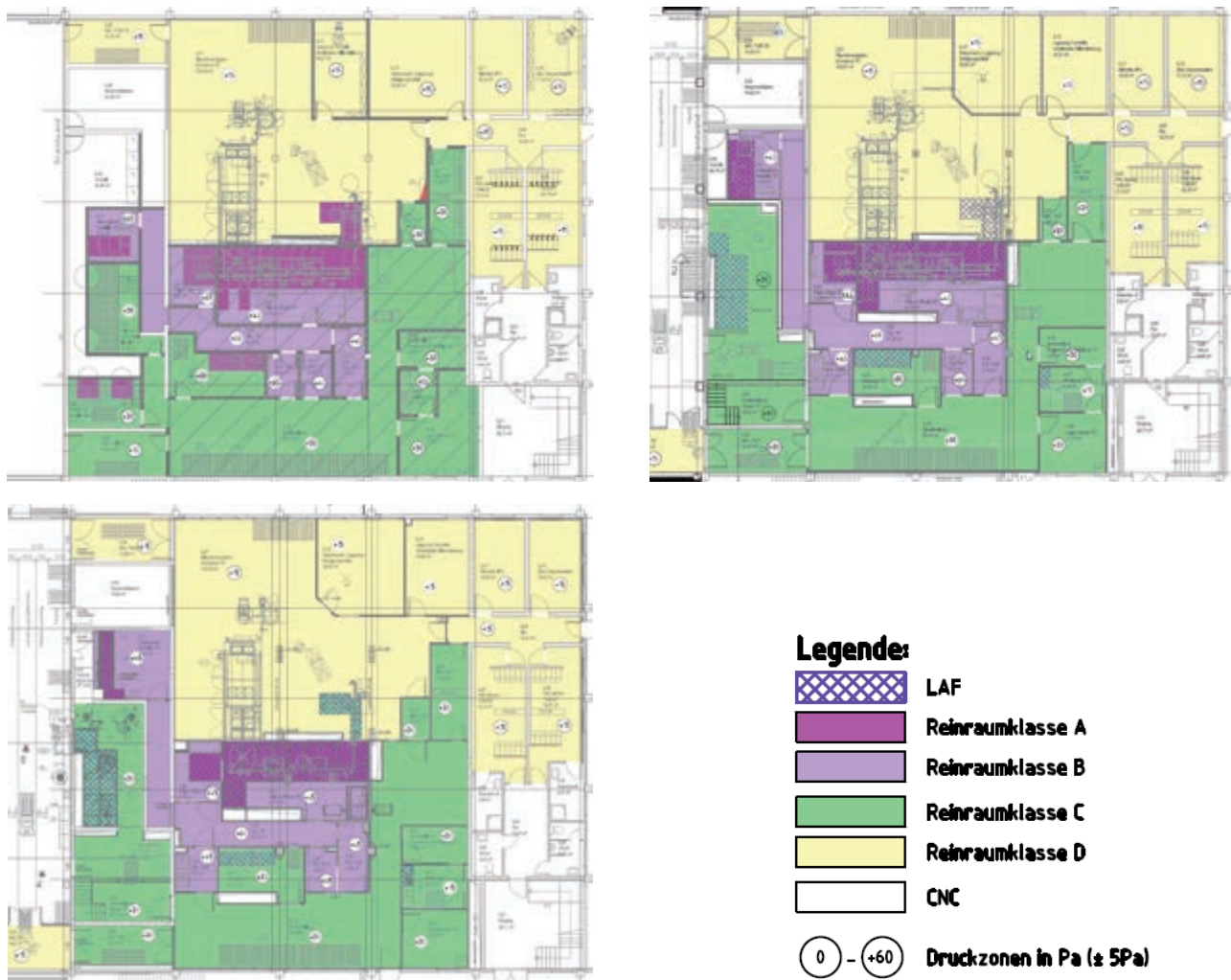
Abbildung 4: Layout GMP-Bereich, links oben: Conceptual Design im März 2015 (entspricht etwa Leistungsphase 2 nach HOAI [10] bzw. Idealplanung nach [1]), rechts oben: Basic Design im Juni 2015 (entspricht etwa Leistungsphase 3 nach [10] bzw. Detailplanung nach [1]), links unten: As built im Aug. 2016. Jeweils linke mittlere Achse: Ansatzbereich (Quelle: M+W CE).
