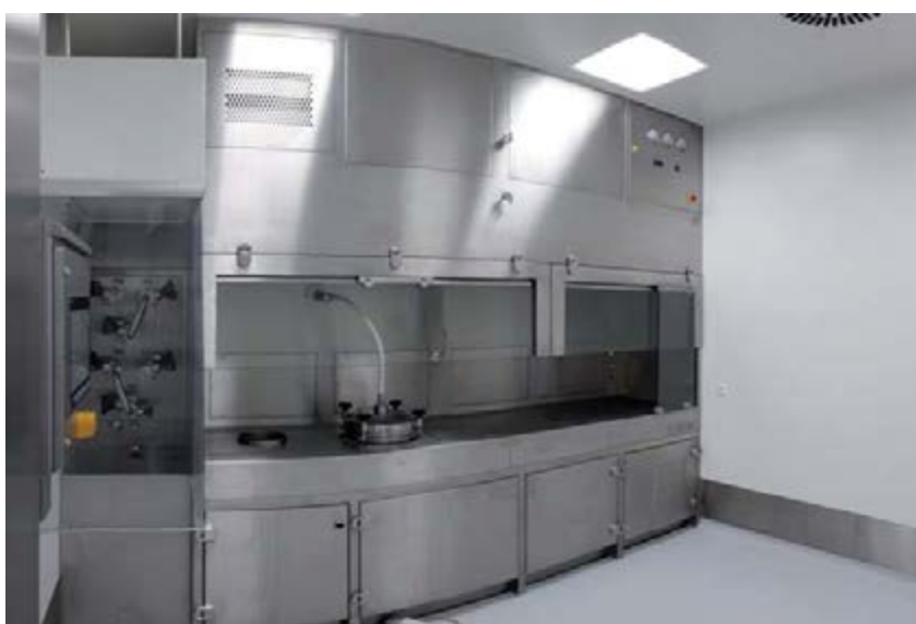
Abbildung 2: LAF-Sicherheitswerkbank (Franz Ziel) mit Dispergiertrichter (Ystral), links daneben Koppelpaneel (Plantech Engineering) (Quelle: M+W CE).
