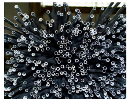
Abb. 6: Bei der Trocknung von Rohrbündeln mit Kleinstrohren spielt die exakte Luftführung im Trocknungstrog eine entscheidende Rolle.
