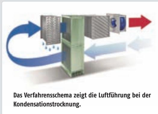
Das Verfahrensschema zeigt die Luftführung bei der Kondensationstrocknung.
