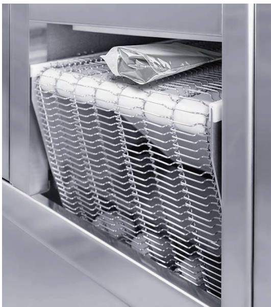
Bei vollautomatischen Bandtrocknern (hier mit Standbodenbeutel) werden die vereinzelter Produkte mit gezielter Luftführung getrocknet und gekühlt.
