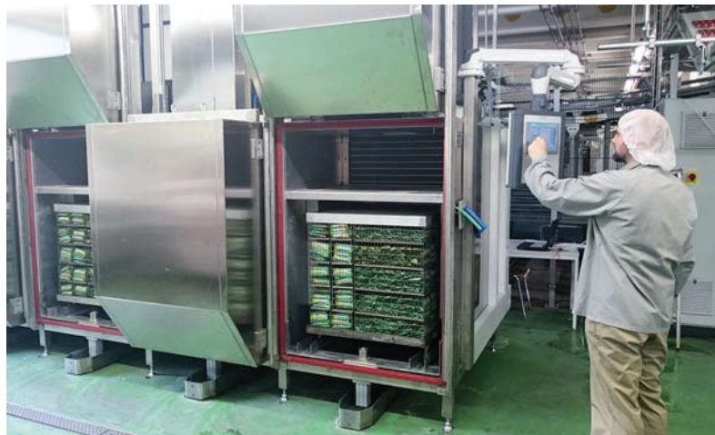
Dieser klassische Chargentrockner kann für pharmazeutische Erzeugnisse ebenso eingesetzt werden wie für Lebensmittel.
