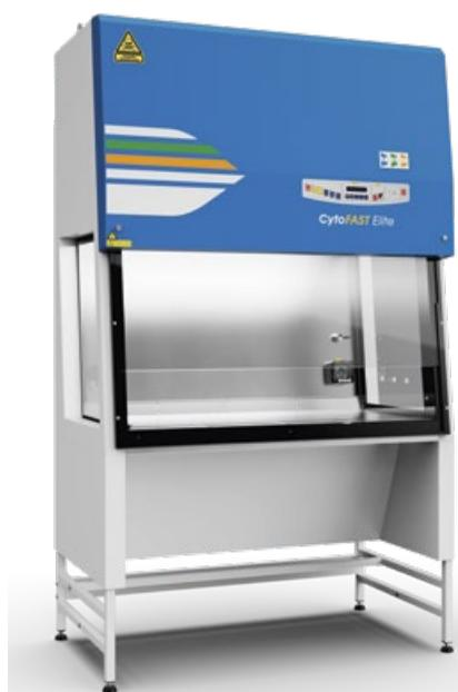
Die CytoFAST Premium ist eine Zytostatika Sicherheitswerkbank, die sowohl zum Schutz des zu behandelnden Materials vor Verunreinigungen, als auch zum Schutz des Anwenders und der Umgebung vor toxischen Substanzen entwickelt wurde. Bei diesem Luftfiltrierungssystem werden 70 % der Luft über einen Umluftfilter als Laminarflow in den Arbeitsbereich zurückgeführt und 30 % über einen Abluftfilter an die Umgebungsluft abgegeben.
