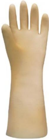
Die Schutzhandschuhe sind für Herstellverfahren geeignet, für die eine gleichbleibende geringe Anzahl von Partikeln notwendig ist. Daher ist der Handschuh für Reinräume bis ISO-Klasse 5 geeignet. Dank der Tri-Polymer-Mischung aus Naturlatex, Neopren und Nitril bietet der Schutzhandschuh erhöhten Tragekomfort und schützt gleichzeitig bestens vor mechanischen und vielen chemischen Gefahren. Die weite Manschette erleichtert das Anziehen von zwei Paar Handschuhen übereinander.
