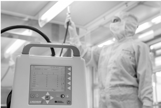
Abb 1. Luftpartikelzähler zur Messung von flugfähigen Partikeln sind zur Überwachung der Luftreinheitsklasse in Reinräumen sehr gut geeignet, können aber nicht zur Erfassung größerer, schnell sedimentierender Partikel eingesetzt werden.
