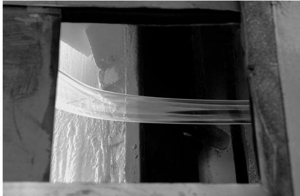
Abb. 4: Herstellung von Glasröhren: Die Glasschmelze wird aus der Wanne abgelassen.
