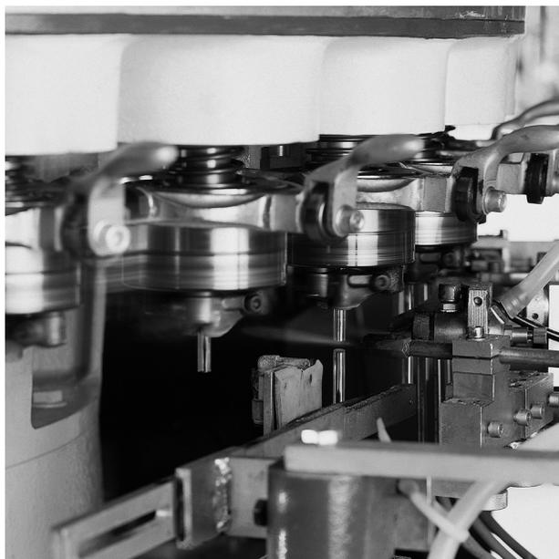
Abb. 8: Spritzenherstellung: Verschmelzen der Röhrenden.
