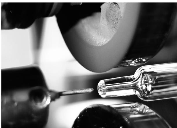
Abb. 10: Spritzenherstellung: Konusformung.
