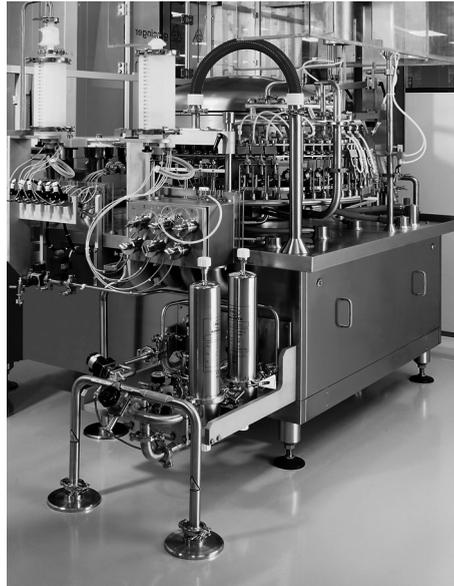
Abb. 16: RTF-Produktion: Waschung und Silikonisierung.
