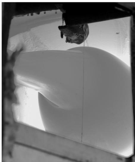
Abb. 5: Herstellung von Glasröhren: Die Glasschmelze wird über rotierende Rundkörper gezogen.
